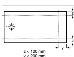
Los lados cortados deben ir a pared o enrasados en el plano suelo. Posibilidad de corte: ver dibujo.
