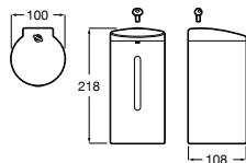
**Dispensador de jabón o gel hidroalcohólico con sensor
